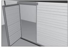
После сборки необходимо проверить работу калитки. Полотно калитки должно быть выставлено по уровню, без перекосов и зазоров, а в закрытом состоянии по периметру оно должно равномерно прилегать к щиту ворот.
