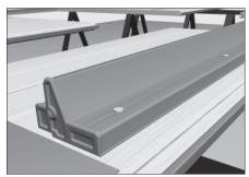
Справа и слева на верхний усилитель установите крышки усилителя и закрепите их с помощью саморезов. Допускается вместо саморезов использовать заклёпки.
