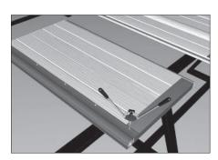
Установите алюминиевый профиль нижний несущий на нижнюю панель. Просверлите отверстия  $\varnothing 4,2$  мм с шагом не более 500 мм и закрепите профиль с помощью заклёпок.
