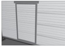
Выровняйте по линейке все профили на полотне калитки и закрепите с помощью заклепок.
