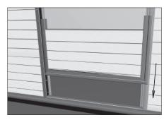
Установите на нижний сегмент калитки горизонтальный и боковой Ц-профили и П-профиль (последний устанавливается с той стороны, где крепится петля). Установите нижний сегмент в проем калитки, обеспечивая зазор 10 мм между сегментом калитки и низом проема.
