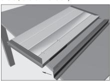
Вставьте закладной элемент для доводчика в панель таким образом, чтобы его отверстия совпали с отверстиями, просверленными в панеле. Установите Ц-профиль обратно на панель.
