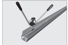
Установите стальной C-профиль во внутреннюю камеру нижнего несущего профиля по всей его длине. Закрепите C-профиль заклепками с шагом не более 500 мм.
