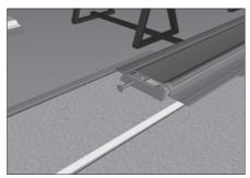
Задвиньте по пазам алюминиевый профиль карниз малый и установите справа и слева крышки профиля малого карниза. Закрепите крышки саморезами (допускается использовать заклепки).
