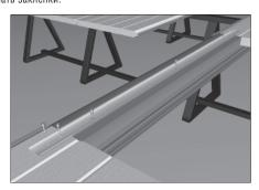
Переверните панель с установленным на нее верхним усилителем. Установите в паз верхнего ригеля усилитель карниза, расположите симметрично относительно центра проема калитки и закрепите его с помощью саморезов по отверстиям, сделанным на производстве.
