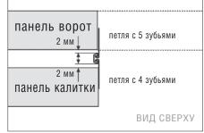
От длинномерной заготовки отрежьте заготовки петли необходимой длины (зависит от высоты панелей). Просверлите отверстия  $\emptyset$ 4,2 мм в заготовленных петлях.
