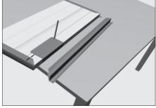
Расположите верхний сегмент калитки внутренней стороной вверх и снимите с него верхний Ц-профиль. Сверху на панель со стороны П-профиля положите закладной элемент для доводчика на расстоянии 52 мм от края панели. По отверстиям в закладном элементе разметьте и просверлите 4 отверстия в панели под крепление доводчика.
