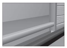
Установите снизу по краям проема заготовки Ц-профилей. Отрежьте алюминиевый профиль порог калитки согласно ширине проема калитки, за вычетом толщины стенок боковых Ц-профилей. Вставьте порог в паз нижнего несущего профиля.
