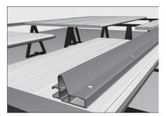
Просверлите отверстия  $\varnothing$ 13,2 мм в верхней стенке алюминиевого профиля усилителя верхнего с шагом, указанным в карте цех. Закрепите профиль сквозь эти отверстия к панели с помощью саморезов.
