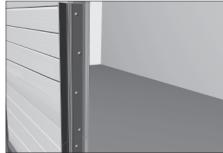
Нижняя и верхняя петли устанавливаются с учетом зазора 10 мм. Остальные петли установите вплотную друг к другу, стык в стык.
