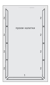
Из длинномерных заготовок алюминиевого профиля изготавливаются заготовки окантовки проема и полотна калитки. Длина боковых заготовок должна быть больше высоты панели на 20 мм, а длина верхних и нижних заготовок быть больше ширины проема калитки на 20 мм.
