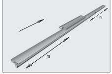
Возьмите алюминиевый профиль усилитель верхний и вставьте в него стальной С-профиль. С обратной стороны профиля усилителя установите по пазам алюминиевый профиль ригель верхний. Где п — это В1-75 мм (либо В1-150 мм в случае двойных боковых опор), а m — это В2-75 мм (либо В2-150 мм в случае двойных боковых опор).
