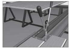
Закрепите карниз по краям к сэндвич-панели с помощью заклепок.
