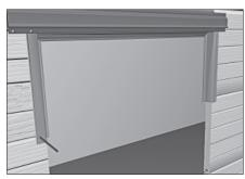
Установите верхние боковые Ц-профили. По месту отмерьте их длину, ориентируясь по середине стыков панелей, и отрежьте с помощью ножовки по металлу.
