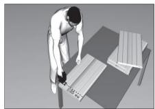
Каждый сегмент полотна калитки укоротите по длине на  $35 \ \text{мм}$ .
