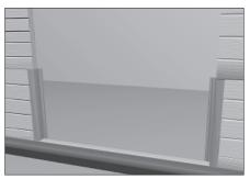
По месту отмерьте длину бокового Ц-профиля, ориентируясь по середине стыков панелей и отрежьте с помощью ножовки по металлу.
