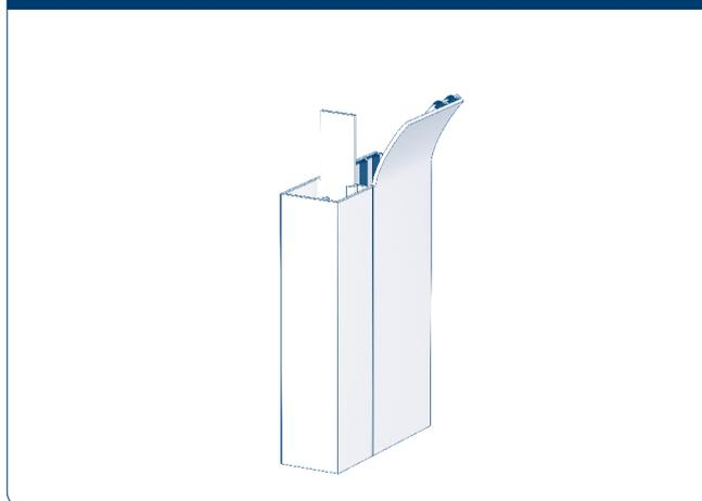
Для профилей серии RG84M и RG84GM направляющие RG90MS увеличили на 40 мм для создания формовки и отгиба.
