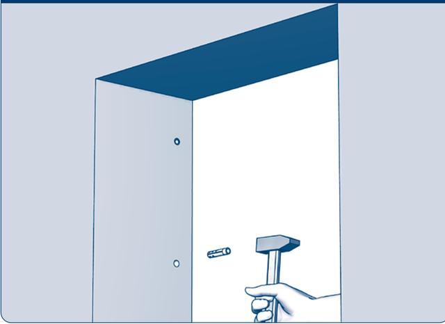
**Встроенный монтаж.** Установите дюбели в отверстия в стене для крепления короба и направляющих в проеме.
