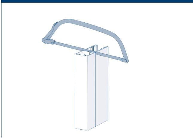
Для профилей серии RHE56M и RHE56GM направляющие RG65MS увеличили на 30 мм для создания формовки на объекте. Формовка и отгиб выполняются перед монтажом.
