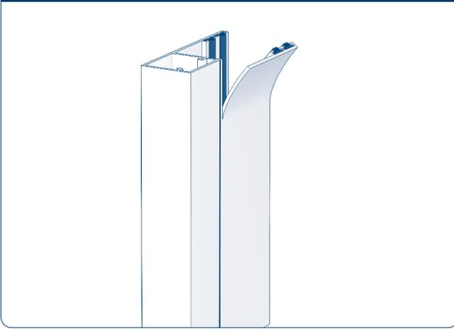
После установки направляющих роликов рекомендуется сделать отгиб для более плавного хода полотна.
