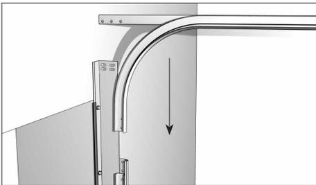
Горизонтальные направляющие постав- ляются в сборе с С-профилем, служащим для повышения жесткости направляющих. В С-профиле и в горизонтальных направ- ляющих сделаны отверстия для крепления с вертикальными направляющими и угловой стойкой.
