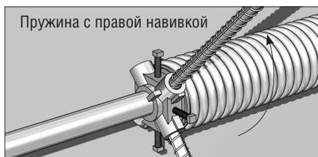
На пружине проведена краской специальная разметочная полоса, служащая для указания количества закрученных витков пружины. Расчетное число оборотов указано в монтажной карте и на наклейке на полотне ворот.
