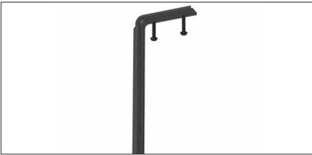
Просверлите отверстия сверлом  $\varnothing 10$  мм и вставьте дюбели. Закрепите кронштейн при помощи саморезов с шайбами.
