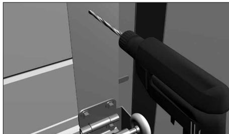
Просверлите отверстия  $\varnothing 4,2$  мм для крепления задвижки и отверстие  $\varnothing 15$  мм в угловой стойке для вхождения ригеля задвижки.
