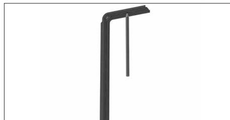
Закрепите кронштейн к горизонтальной направляющей при помощи закладной пластины и болта с гайкой.
