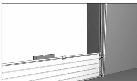
Выверните нижнюю панель по строительному уровню. При необходимости используйте подкладки соответствующей толщины.
