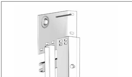
Установите концевой опорный кронштейн по отверстиям на угловой стойке и по перфорации в нем разметьте отверстия для крепления в стене проема.
