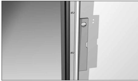
Закрепите угловые стойки к стене проема двумя саморезами с шайбами, но не затягивайте их. Выставьте вертикальные направляющие по уровню и только после этого затяните саморезы.
