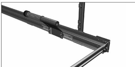
Закрепите пружинный амортизатор с помощью закладных пластин и болтов с гайками. Отрегулируйте положение амортизатора и затяните гайки.
