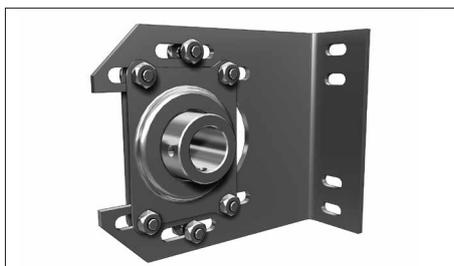
В случае установки вала 31,75 мм вместо обычных концевых опорных и универсального внутреннего кронштейнов используются кронштейны с регулируемым подшипником. Кронштейны имеют дополнительные отверстия для крепления к стене и угловой стойке.
