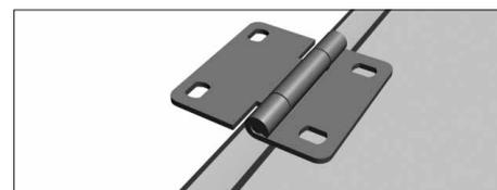
Установите внутренние петли по отверстиям в панели, ранее сделанным на производстве. Отверстия в нижней части петли должны совпадать с отверстиями в панели, сделанными на производстве. Закрепите петли при помощи саморезов для панелей ворот по аналогии с нижней панелью.
