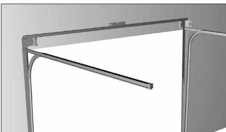
Проверьте горизонтальность установки крон- штейнов с помощью С-профиля (допускается использовать лазерный уровень).
