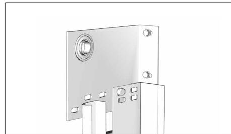
Закрепите к стене концевой опорный кронштейн при помощи дюбелей и саморезов.
