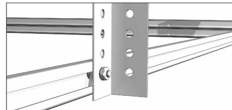
Закрепите перфорированный уголок 32 × 32 мм при помощи двух болтов на универсальный угловой кронштейн.
