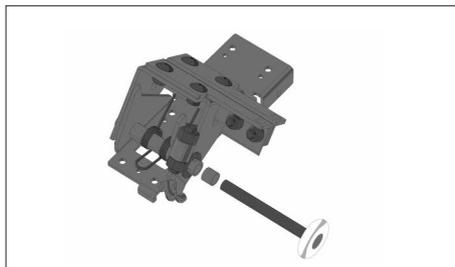
В зависимости от типа нижнего углового кронштейна подберите и установите распорные втулки на оси роликов в нижних угловых кронштейнах.
