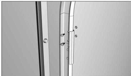
Скрепите горизонтальные и вертикальные направляющие между собой при помощи двух болтов для сборки направляющих с гайками и с соединительной пластиной, располагаю- щейся в месте стыка направляющих.
