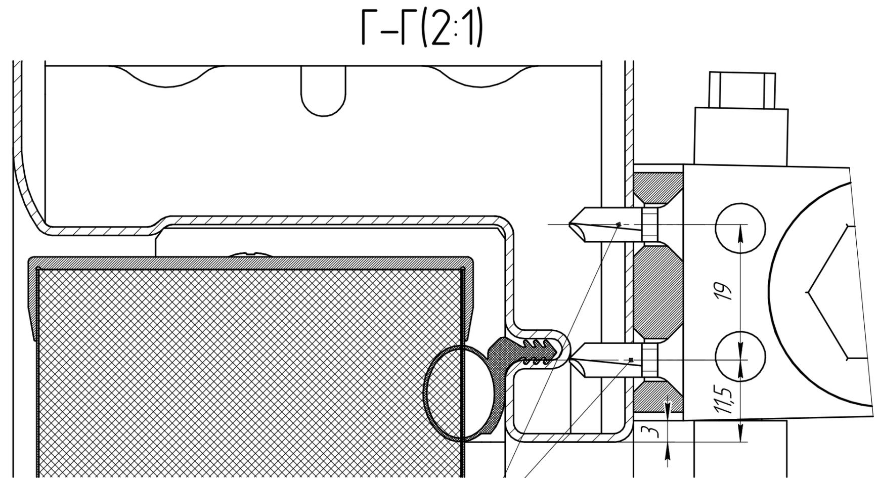
Саморез/D=4,8мм/L=16мм/с потайной головкой со сверлом/
